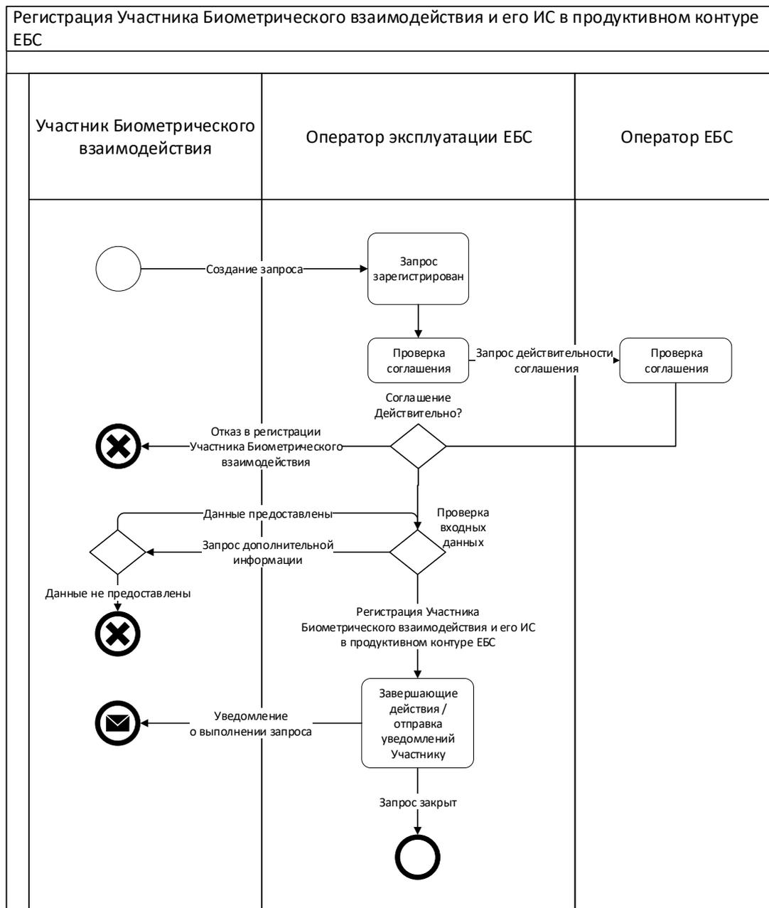
**Рисунок 2** Схема процесса «Регистрация Участника Биометрического взаимодействия и его ИС в продуктивном контуре ЕБС»
