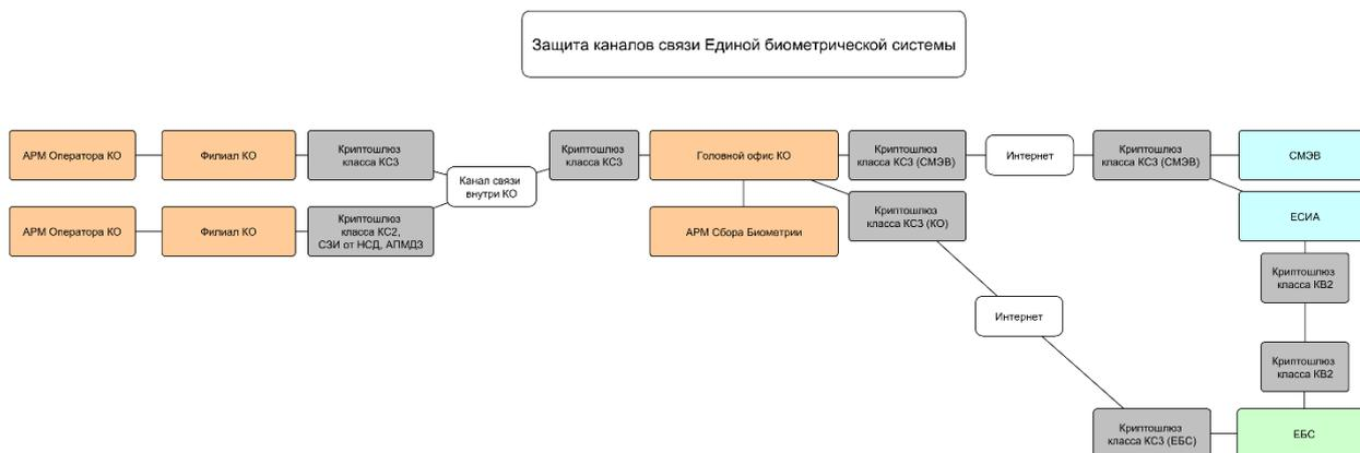
Рисунок 5. «Защита каналов связи с использованием оборудования класса КС3(владелец оборудования - КО)»
